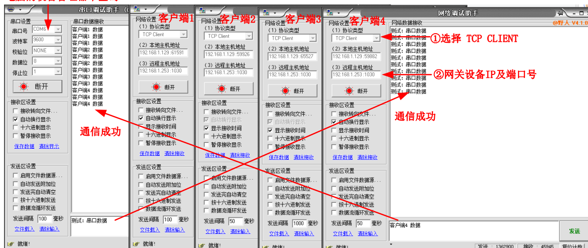
图 3.4 TCP SERVER 模式下连接多个客户端
