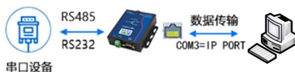
图 3.20 虚拟串口工作原理
