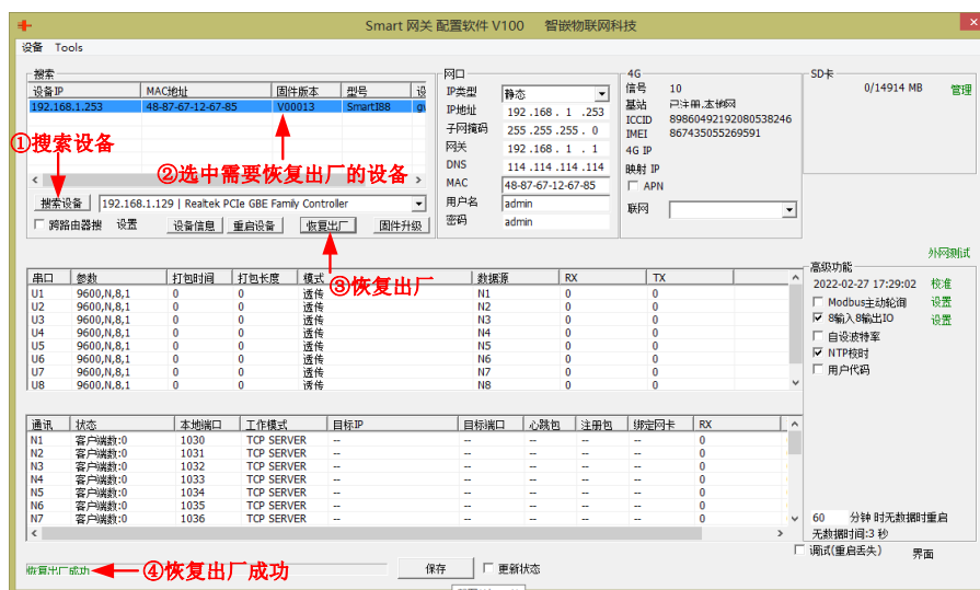
图 8.2 用配置软件恢复出厂步骤
