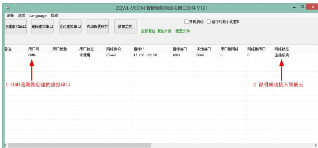
图 4.30 虚拟串口接入智嵌云并绑定设备步骤
