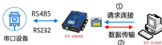
图 3.2 TCP SERVER 模式工作原理
