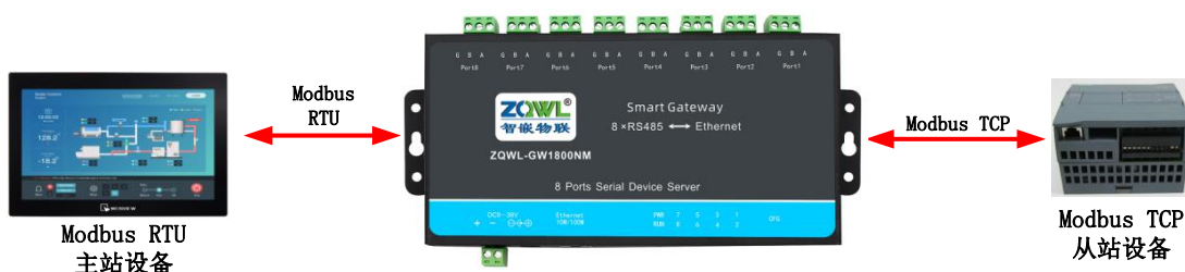
图 3.26 ModBus TCP/RTU 互转（主）模式应用框图
