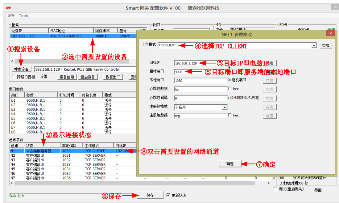
图 3.6 N1 通道配置为 TCP CLIENT 模式
