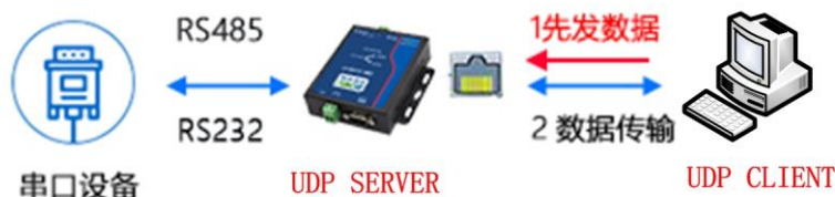
图 3.8 UDP SERVER 模式工作原理
