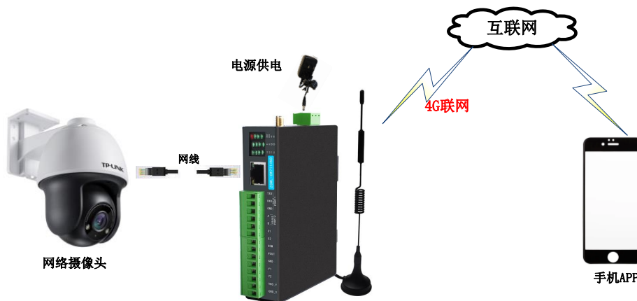
图 4.5 远程传输网络摄像头数据示意图
