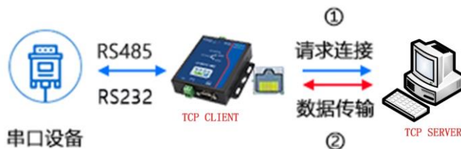
图 3.5 TCP CLIENT 模式工作原理
