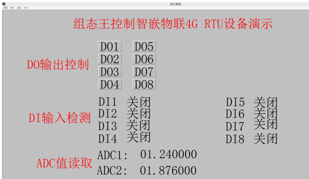
图 10.39 组态王软件读取 4G RTU 数据
