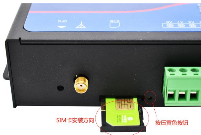
图 3.14 SIM 卡安装方法
