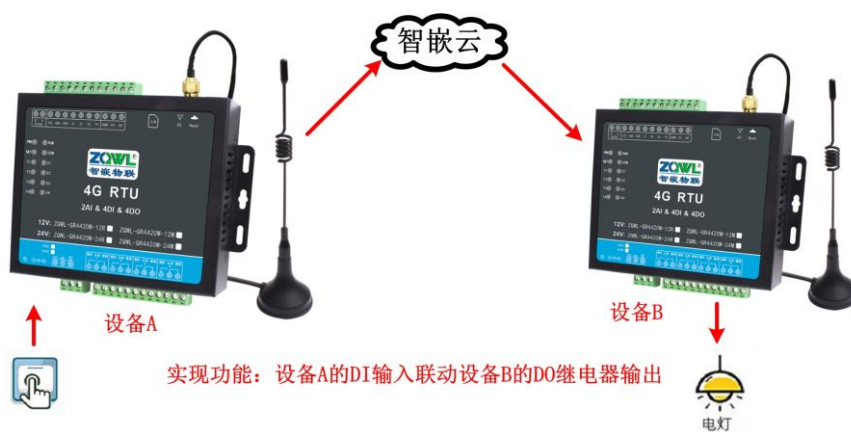
图 10.12 设备之间的远程联动拓扑
