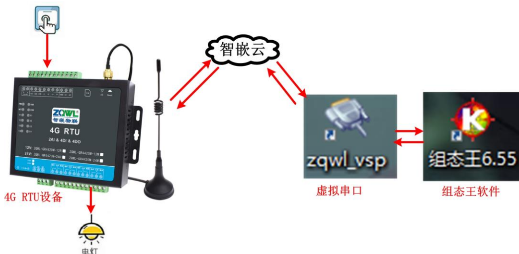
图 10.26 4G RTU 设备利用虚拟串口与组态王通信
