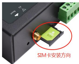
图 2.17 SIM 卡安装方向
