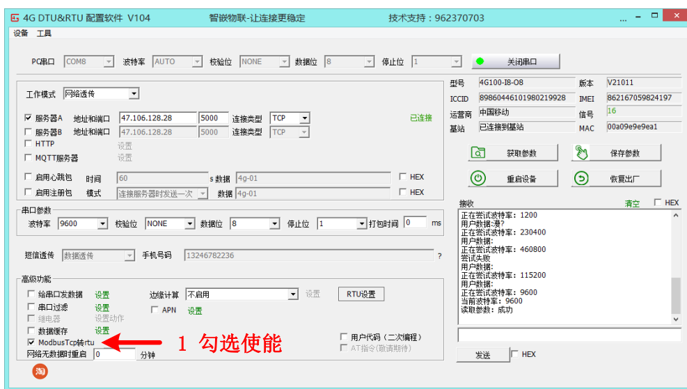
图 4.12 使能 ModBus TCP 转 RTU
