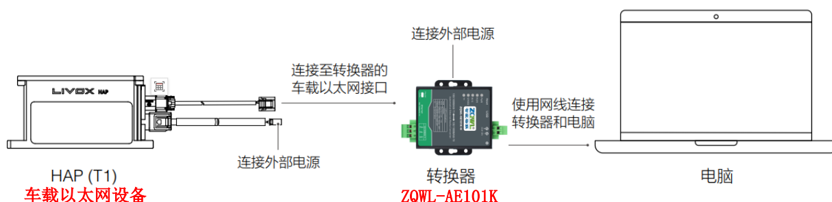
图 2.1 LIVOX 的激光雷达的连接测试示意图
