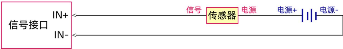
二线制电流信号采集差分接线图
