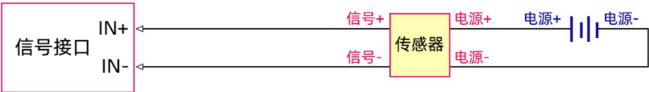
电压信号采集差分接线图
