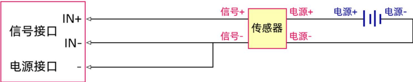
电压信号采集单端接线图
