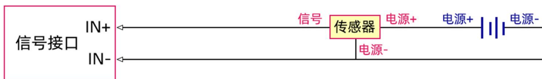
三线制电流信号采集差分接线图
