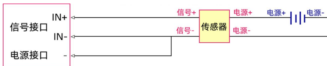
四线制电流信号采集单端接线图
