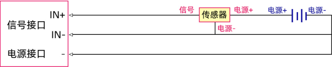
三线制电流信号采集单端接线图
