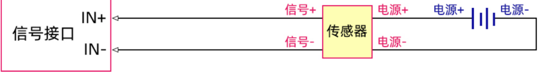
四线制电流信号采集差分接线图
