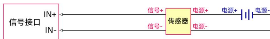
电压信号采集差分接线图
