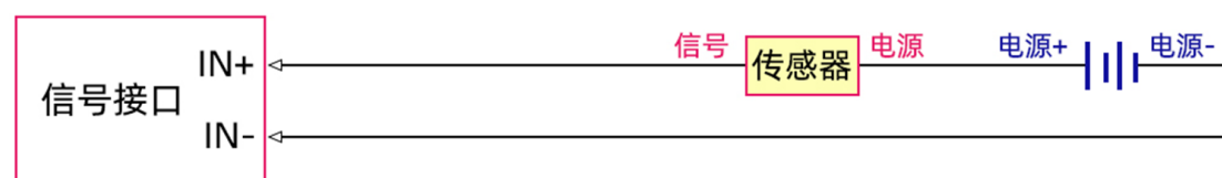
二线制电流信号采集差分接线图
