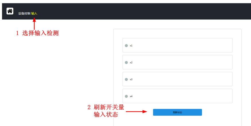
图 9.10 设备开关量输入检测界面
